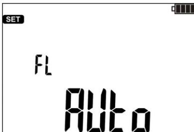
Das Messgerät MIC-5001 verfügt über einen Analogfilter, der den Wechselstromanteil unterdrückt und Messungen in einer Umgebung mit starken elektromagnetischen Störungen ermöglicht.
