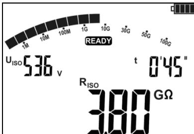
Nach Abschluss oder Abbruch der Messung, werden die Ergebnisse angezeigt. Es werden alle erzielten Messergebnisse angezeigt (sogar, wenn die Messung unterbrochen wurde).
